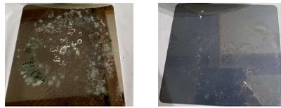
未処理の鏡面ではカビの発育が顕著である一方、MDbio試験片はカビの増殖が抑制されています。
