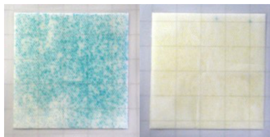
8時間後の大腸菌群培地シート 左: SUS304 未処理、右: MD処理
