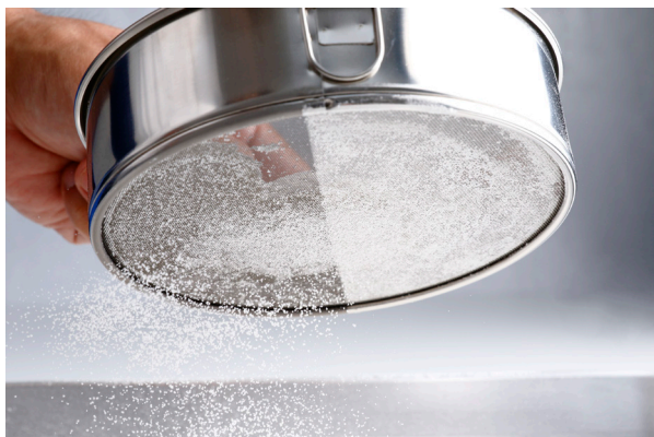
マイクロディンプル処理®を施したフルイ(左半分)では粉落ちが倍増、目詰まりがなく材料ロスが激減するとともに洗浄時間も短縮できる
